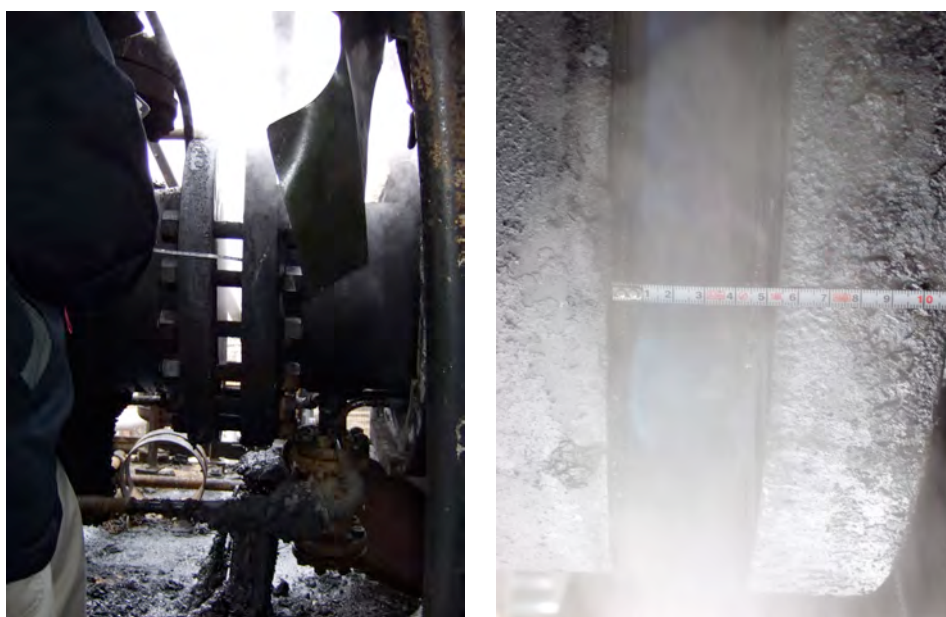
図 2-1 フランジ部 (左図：事故後のフランジ部, 右図：フランジの間隙距離)
