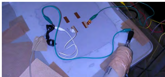
図 14 ペイントの表面抵抗率測定の状態
