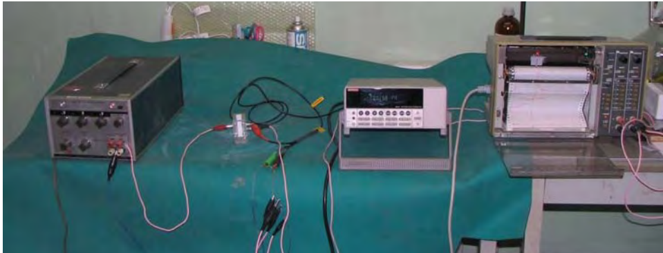
図 11 体積抵抗率測定状況
