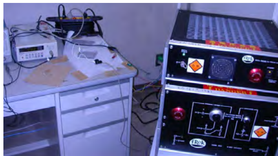
図 13 アクリル容器に塗布されたペイントの抵抗測定
