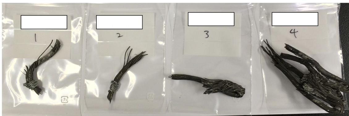
図 2-3 破断したワイヤロープの外観
