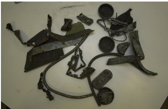
写真 5-1 破碎機内の排出口板上にあったもの
