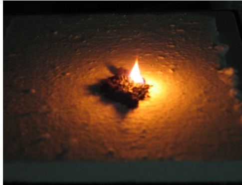
写真 5-7 集じんダクト⑨から採取した粉の燃焼の様子 (F3.2, 1/60s, ISO200 相当)
