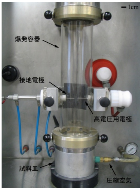
(a) 粉体の最小着火エネルギー測定装置 (Adolf-Kühner, MIKE-3) (b) アルミ粉体の濃度と静電気放電エネルギーとの関係
